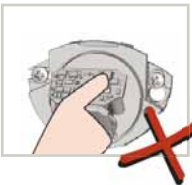
Berührung elektronischer Bauteile vermeiden.
