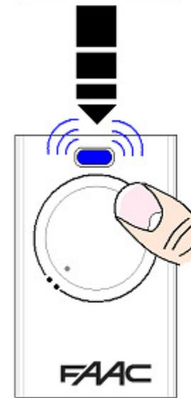
4. Die weiterzugebende Kanaltaste am „Master“ drücken und festhalten. Die LED leuchtet dauerhaft
