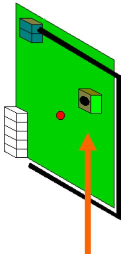
5. Die Programmierstaste an der RP- Platine drücken und festhalten. Die LED an der Platine leuchtet, geht aus und wieder an.
