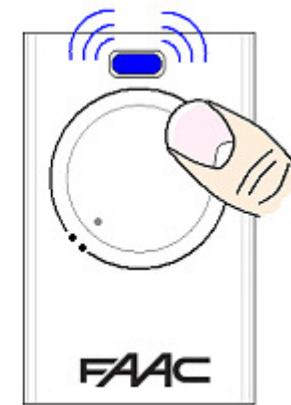
4. Die weiterzugebende Kanaltaste am „Master“ drücken und festhalten. Die LED leuchtet dauerhaft
