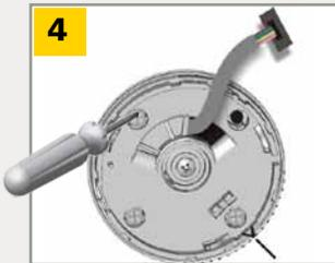
Den Montagesockel positionieren und die 4 Schrauben gut festdrehen um Vibrationen zu vermeiden.
