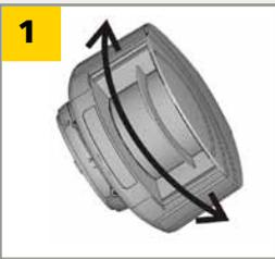
Positionieren Sie die **seitliche Lage** des Erfassungsfeldes.
