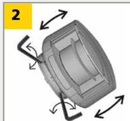
Passen Sie den **Neigungswinkel** des Erfassungsfeldes mit einem Innensechskantschlüssel an.
